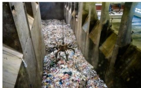
I anlegget på Heimdal blir det årlig brent 220 000 tonn reststoff fra hele Trøndelag, deler av Gudbrandsdalen og sør i Nordland.
